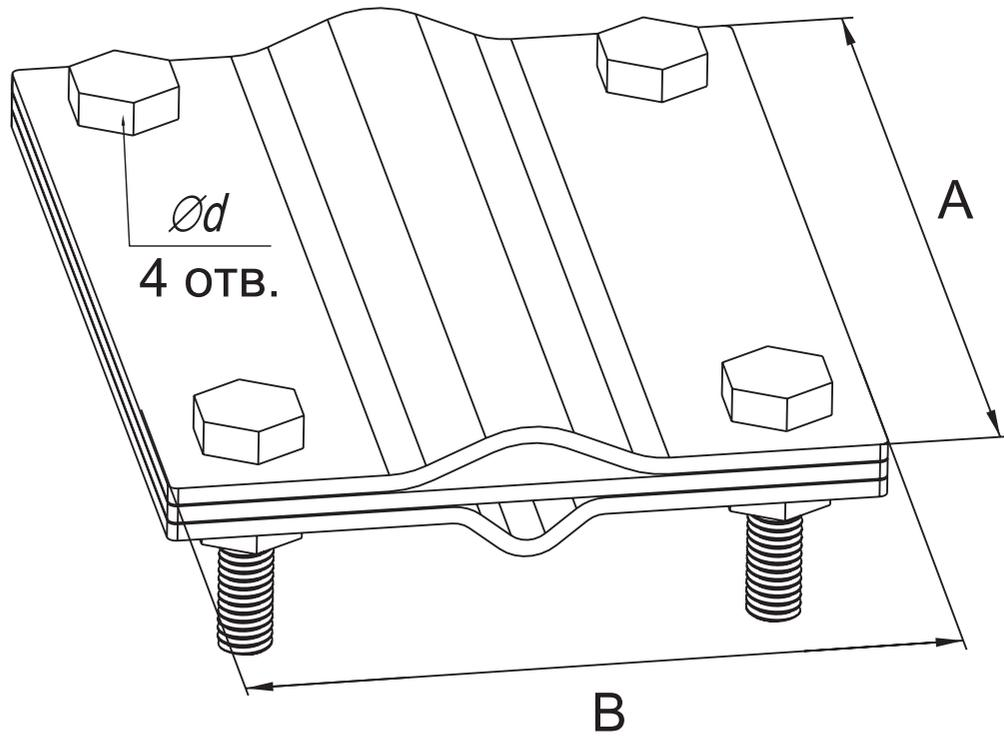
Предназначен для соединения штыря заземлителя  $\varnothing 12-20$  мм с полосой шириной до 40 мм или токоотводом 8-10 мм.
